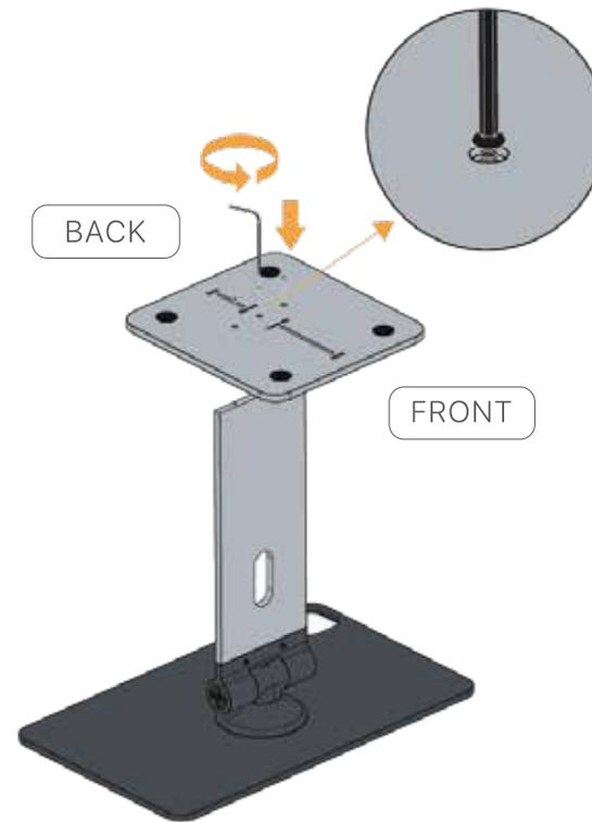
3 前面が長い方のベースを支柱プレートにセットします。3 本のネジを締めます。
