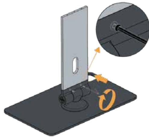
2 支柱プレートを挿入します。ネジ 2 本を締めます。
