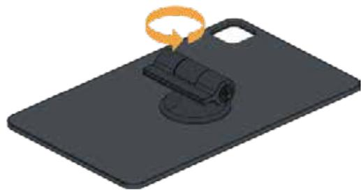
1 ヒンジを左に 90 度回転させます。その後、ヒンジを上向きにします。
